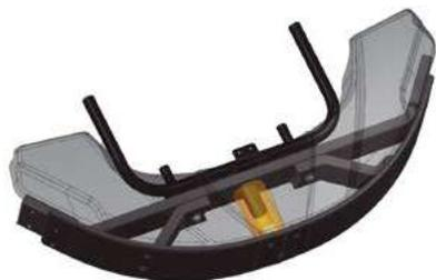
Sistema de **absorción de impactos** diseñado, desarrollado y fabricado por **BRBkarts**
